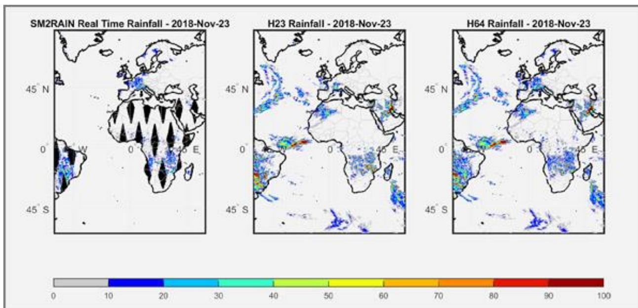
Abbiamo sviluppato un nuovo prodotto di pioggia satellitare in tempo reale. Il prodotto, denominato H64, è basato sull'integrazione di dati di pioggia provenienti da 2 fonti satellitari. L'algoritmo sviluppato infatti combina stime di pioggia ottenute tramite l'applicazione dell'algoritmo SM2RAIN a dati satellitari di contenuto d'acqua e quelle fornite da un prodotto allo stato dell'arte già operativo sull'area full-disk dei satelliti Meteosat (60° Ovest-60° Est, 60° Sud-75° Nord).
