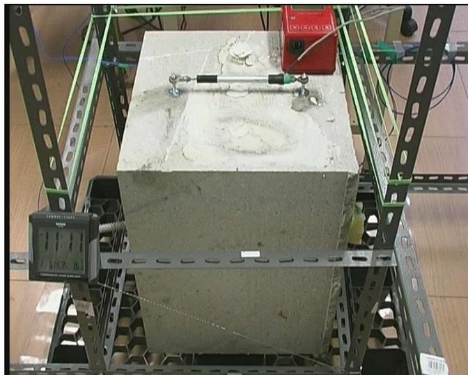
L'attività sui sensori per la valutazione della stabilità degli argini ha portato allo sviluppo di un sensore di pressione e di temperatura per rilevare moti anomali di filtrazione. Il sensore è stato premiato dalla Società Italiana di Elettromagnetismo (SIEm) come idea imprenditoriale innovativa.
