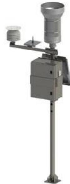
ALMOND-F è una centralina per il rilevamento microsismico delle [colate di detrito](#) effettuato attraverso una rete di [geofoni](#).
